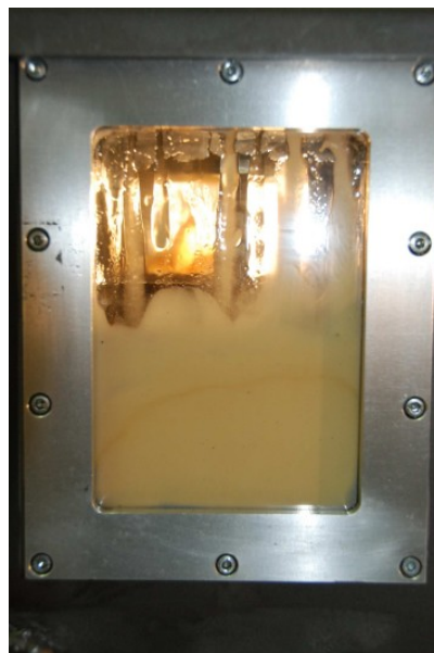
Air-Mix에 의해 형성된 오일-공기의 균일 혼합 상태
