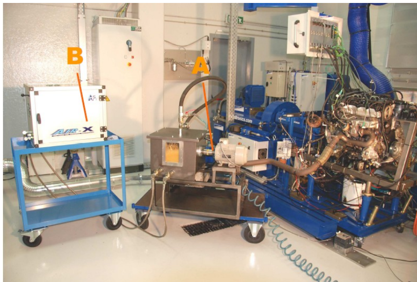
AIR-MIX 장치가 시험실에 설치되어 있는 내연기관에 에어레이션이 발생된 오일을 공급하는 모습
