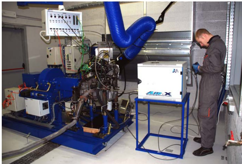
엔진 동력계 시험실 내부에 설치된 Air-X의 샘플링 장치의 모습
