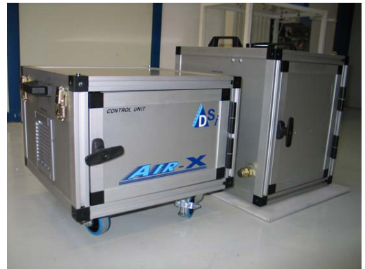
틸트-테스트 베드를 위해 제작된 특수 구성: 우측의 Hydraulic unit을 왼쪽의 컨트롤 유닛으로부터 분리해낸 모습 (컴팩트 구조로 만들기 위함)
